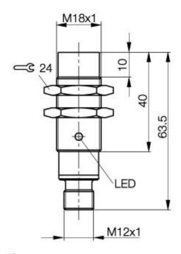
Induktiver Näherungsschalter BES M18ME1-NSC20F-S04G M18x1 x 63.5 Schließer Sn=20mm nicht bündig einbaubar
